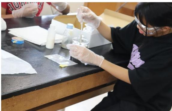
廃液に凝集剤を加えて攪拌するとワックスが分離凝集。中和できているか？リトマス紙で調べる
